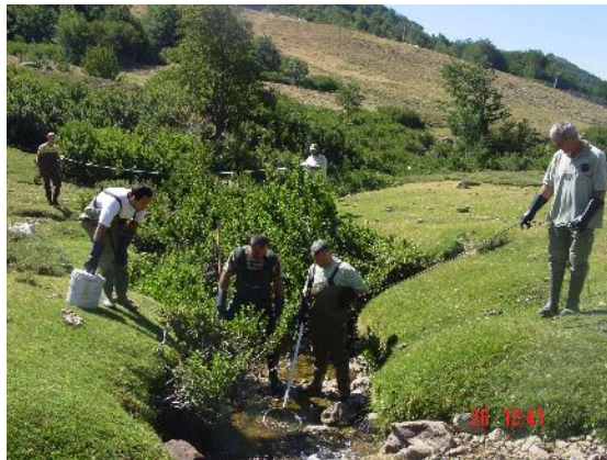
Figure n° 3: pêche électrique pour l'inventaire
